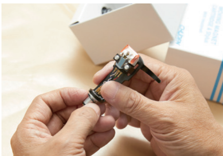
中電で作っているのは「MM型」と呼ばれるレコードカートリッジ。マグネットが振動することでコイルに電圧が生まれ、出力されます
